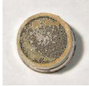
Eine Essiglösung (drei Teile Wasser, ein Teil konzentrierte Essigessenz) oder Kalklöser entfernen Kalkablagerungen. Die Dauer der Behandlung richtet sich nach dem Verschmutzungsgrad.
